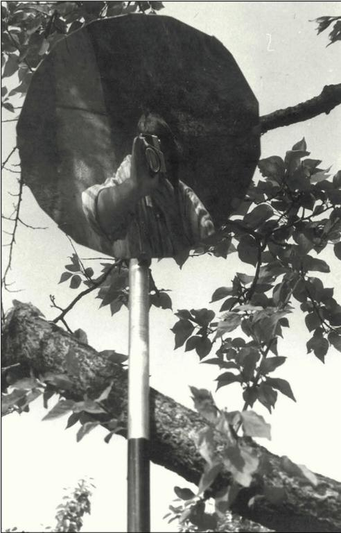
**Abb. 32:** Metallspiegel und Gestänge beim Probebetrieb 1986.
